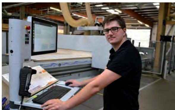
Die CNC-Nesting-Fräse fräst die Teile dann aus.
