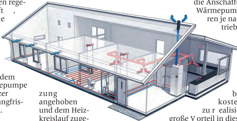
zung angehoben und dem Heizkreislauf zugeführt. Das System arbeitet besonders wirtschaftlich in gut gedämmten Häusern mit Fußbodenheizung, da diese mit niedrigen Vorlauftemperaturen zwischen 30 und 50 Grad Celsius betrieben werden. Auch der Fertighaushersteller Hanlo setzt auf das Funktionsprinzip der Wärmepumpe. Die Häuser benötigen durch ihre speziell gedämmten Wandsysteme wenig Heizenergie, die am besten über
